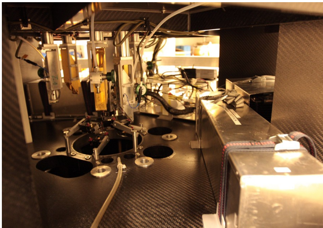
Vue rapprochée d'un des étages de la nacelle SPIRALE, où l'on voit des optiques avec leurs supports et les deux boîtes de l'appareil SARA sur la droite (une partiellement cachée).
