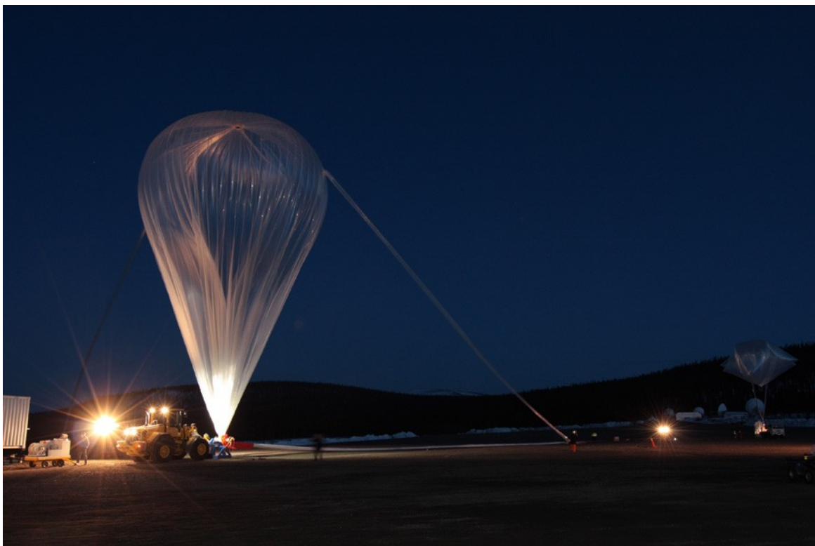
Remplissage du ballon principal. A droite au bout de la chaîne de vol la nacelle SPIRALE soutenue par deux ballons auxiliaires.
